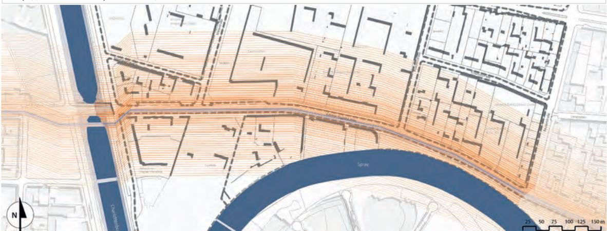
Abb. A6.2: Situation an der Kaiserin-Augusta-Allee: Bis ca. 100m rechts und links der Abwasserdruckleitung können Liegenschaften mittels Wärmetauscher effizient mit Energie versorgt werden
